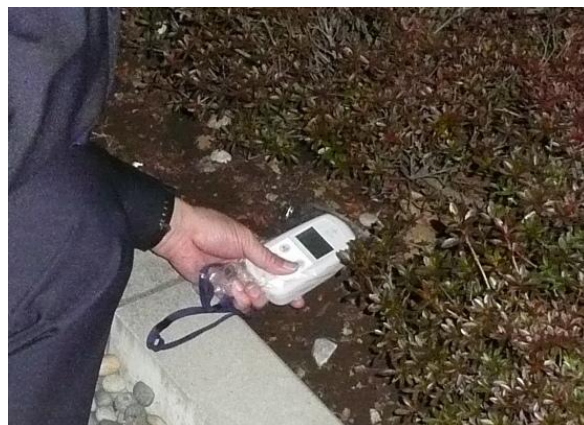
測定方法 (地面等に直に置かない)
