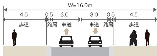
道路断面図(1工区歩道拡幅案)
