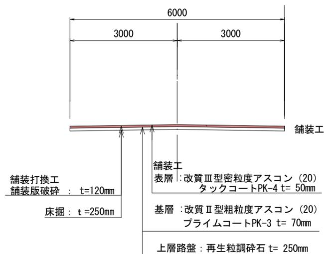
舗装工構造図 S=free
